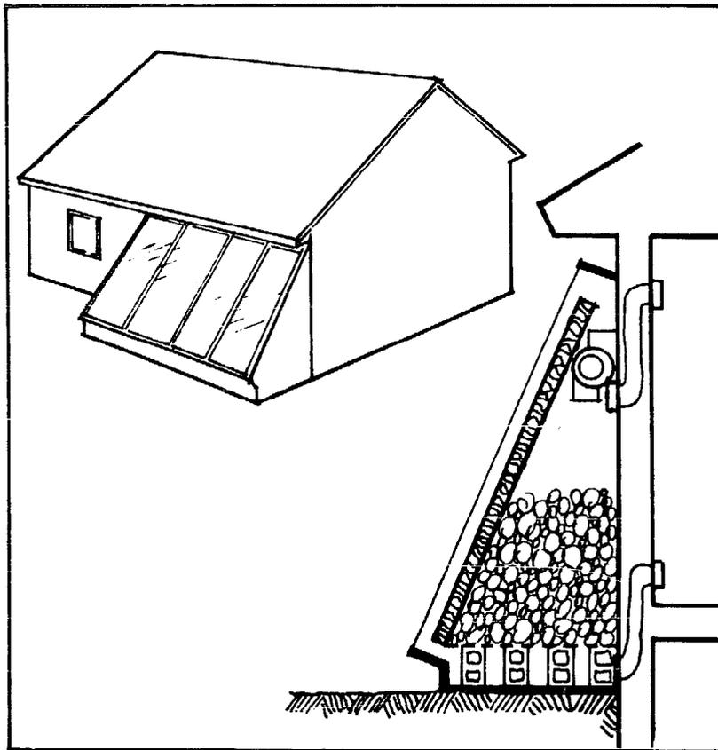
MAKE SURE THAT THE BACK OF YOUR SOLAR ABSORBING SURFACE IS WELL INSULATED SO THAT HEAT STORED IN YOUR ROCK THERMAL STORAGE DOES NOT ESCAPE.
